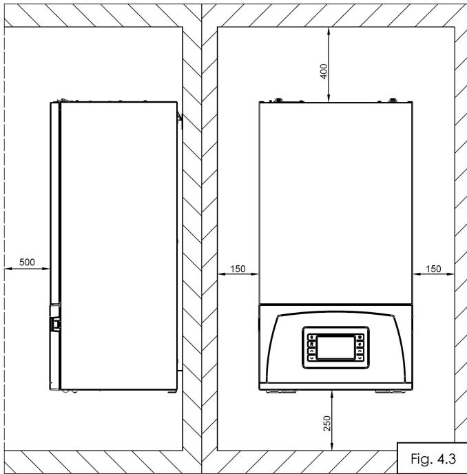
Atât pentru instalarea/montajul centralei, cât și pentru efectuarea unor lucrări ulterioare de întreținere, aveți nevoie de următoarele distanțe minime (fig. 4.3), respectiv spații minime libere pentru montaj:
