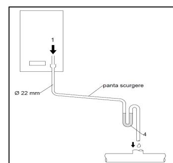
Fig. 5.5 - Eliminare condens in reteaua de canalizare
