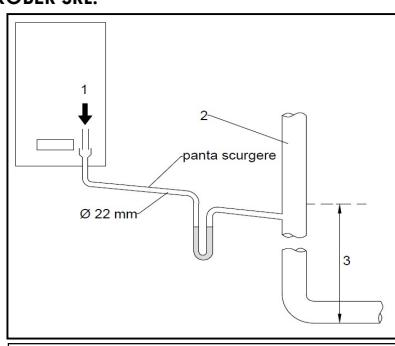
Fig. 5.4 - Eliminare condens in sol ventilat
