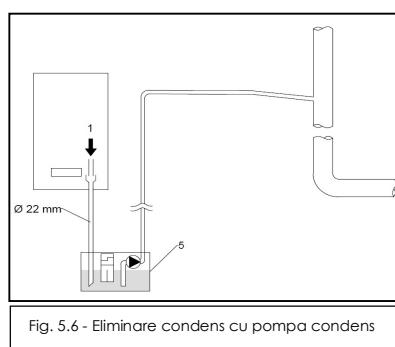
Fig. 5.6 - Eliminare condens cu pompa condens
